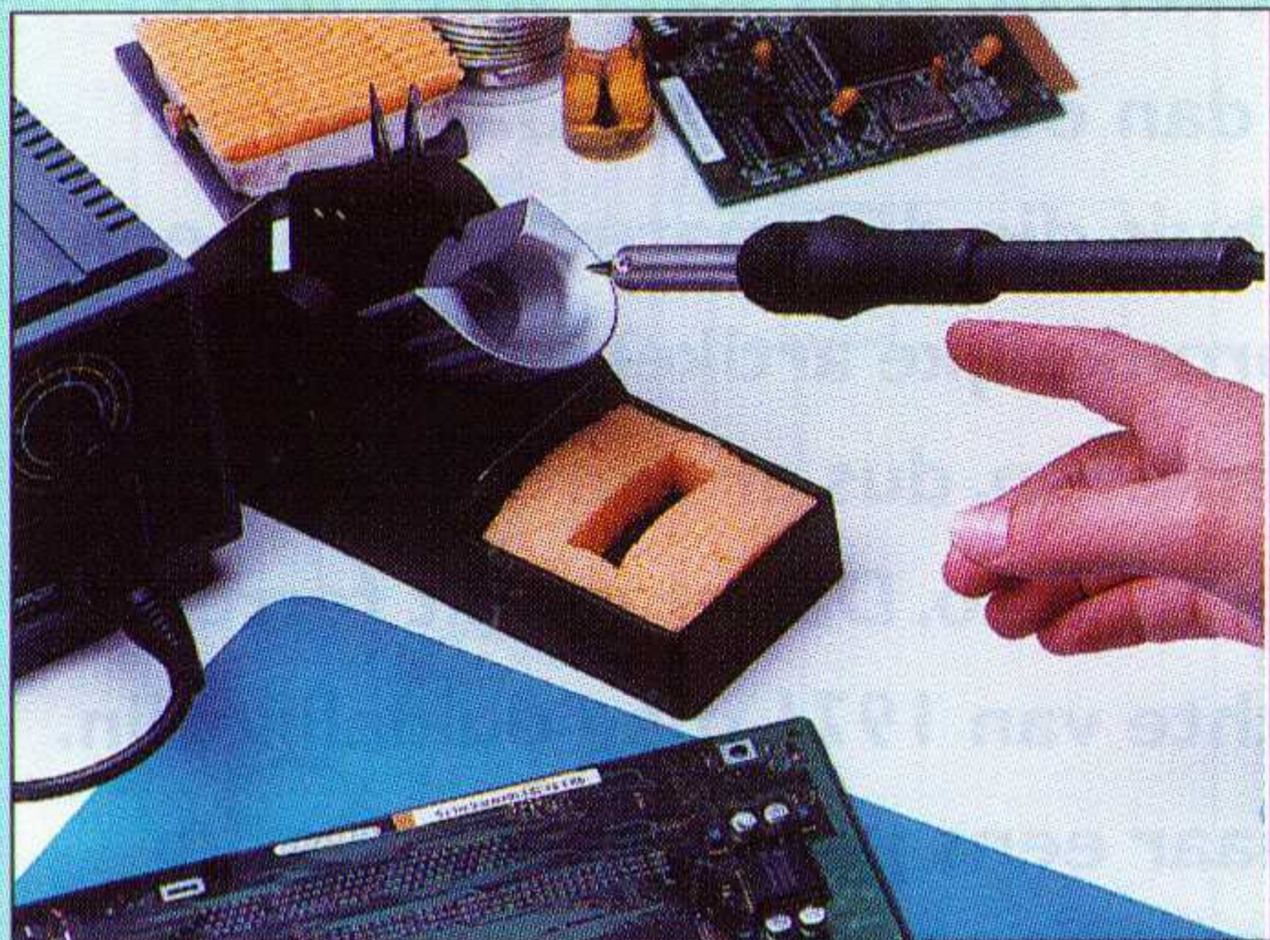
Fig. 12 De SP-80 is een soldeerbout met speciale temperatuurregeling.
